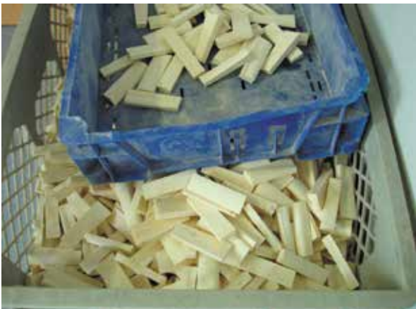
Bein (Knochen) für Bogen-Kopfplatten und Klaviertasten muss in einem aufwändigen Verfahren gereinigt und zugesägt werden Bone, needed for face plates for bows and piano buttons must become cleaned in a luxurious procedure and cut precisely
